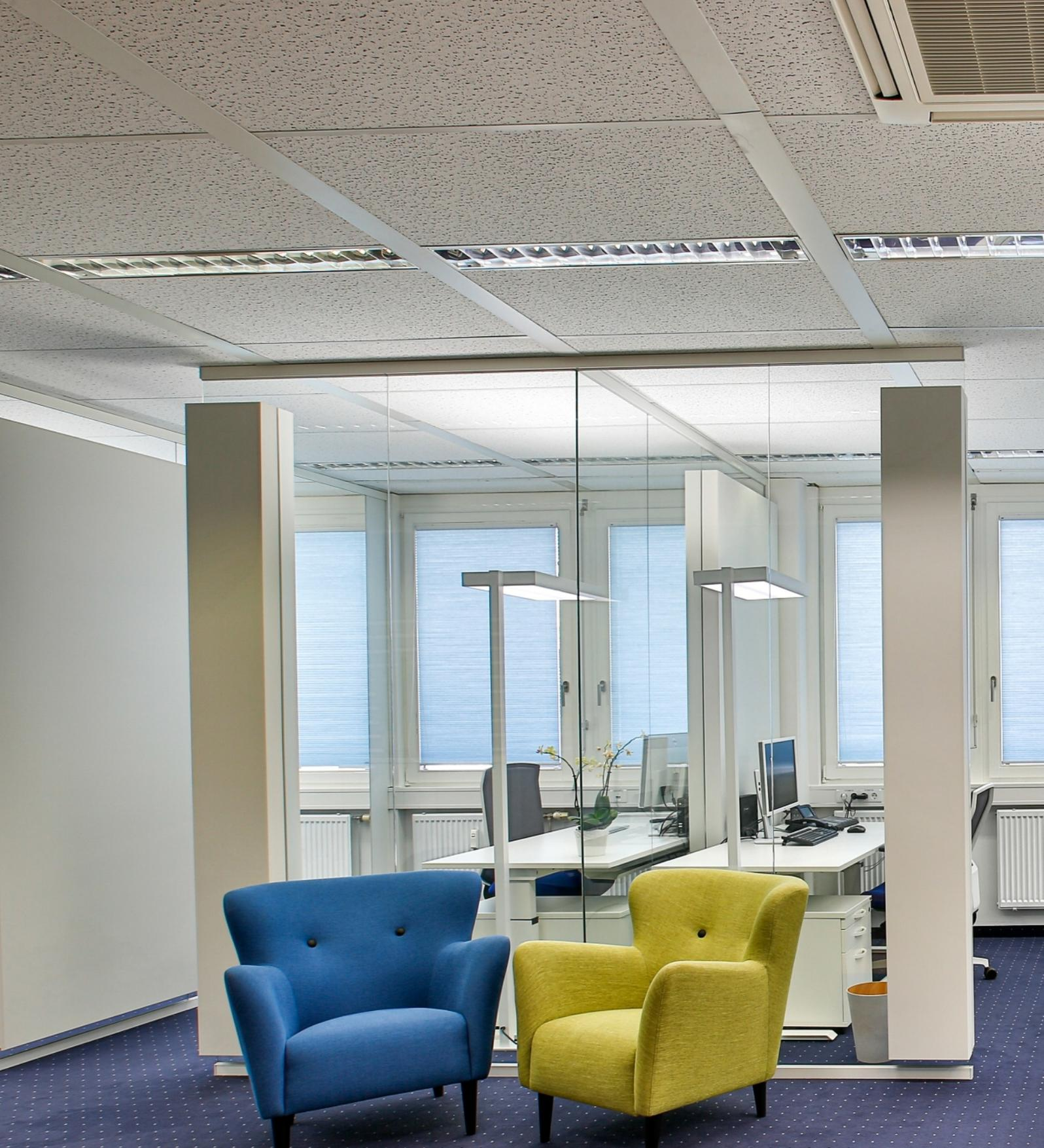
**MVZ Labor Poing. Raum in Raum System eignet sich für offene Büro-Raum-Planungen mit hohen Anforderungen an die Raumakustik und Flexibilität. Ähnlich wie eine Stellwand wird eine Konfiguration aus Trennwand, Glaswand und einer intelligenten Systemstruktur frei auf der Fläche platziert.**
